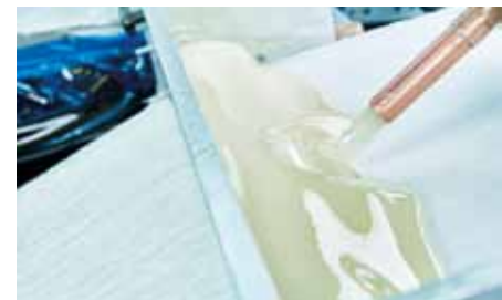
Imprägnierung der Glasfasern mit UP Harz
